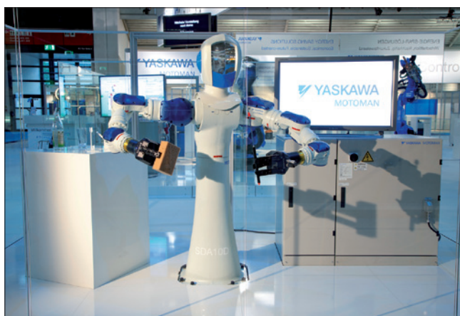
Obr. 1. Dvouruký manipulační robot SDA10D s novým řídicím systémem FS100 automaticky vypíná, není-li v pracovním cyklu
