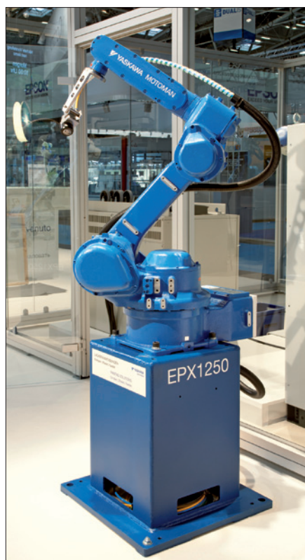
Obr. 2. Kompaktní robot EPX1250 pro robotizované lakování malých dílů
