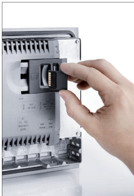
Obr. 5. Práce s paměťovou kartou pro zálohování automatizačního projektu
