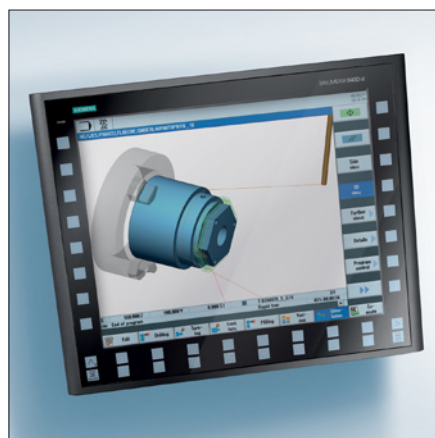
Obr. 3. Dotykový operátorský panel Sinumerik OP 019
