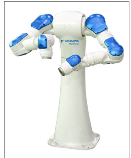
Obr. 10. Dvouřuký robot SDA10F – patnáctiosý robot pro balení, manipulaci nebo montážní operace (Yaskawa)
