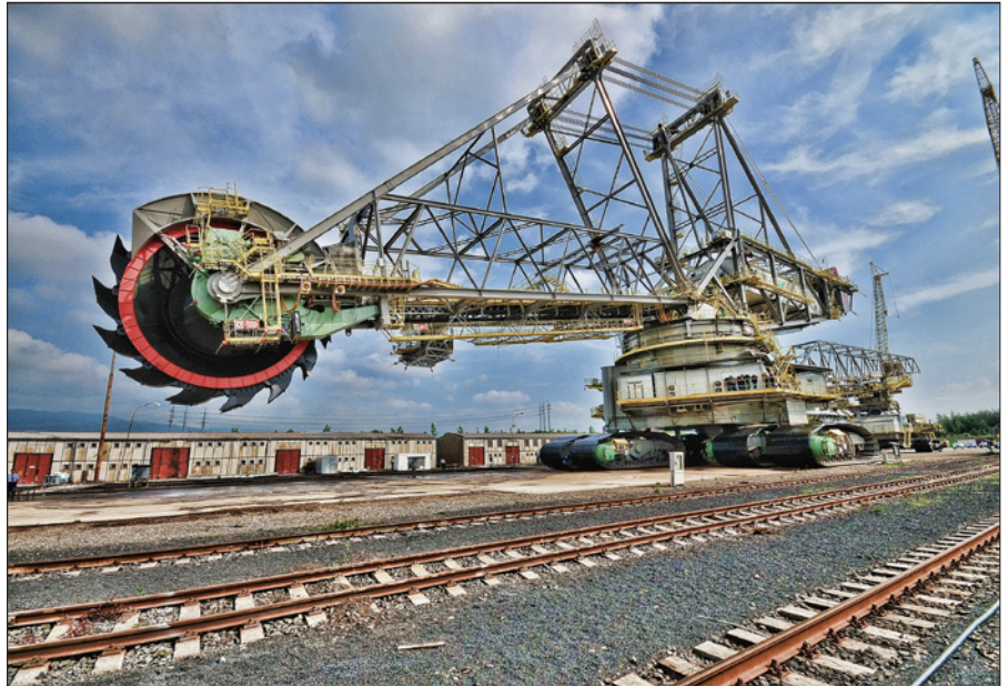
Obr. 2. Do projektu výstavby velkorypadla pro Severočeské doly Siemens dodal řídicí systém, frekvenční měniče, vysokonapěťové rozvaděče a asynchronní motory
