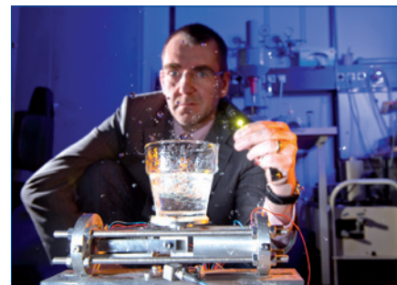
Obr. 2. Zařízení pro „sklizení“ energie generuje z mechanických vibrací – dobře patrných na sklenici s vodou – elektrický proud postačující k rozsvícení světelné diody (foto: Siemens)
