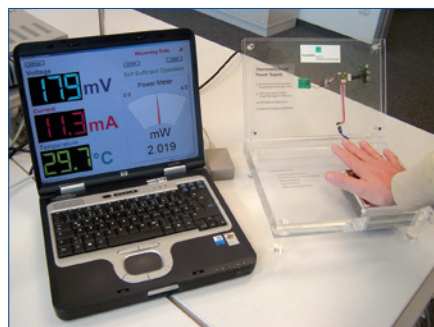
Obr. 1. Termoelektrický generátor mění teplo lidské ruky na elektrickou energii při výkonu asi 2 mW (foto: Fraunhofer IIS)
