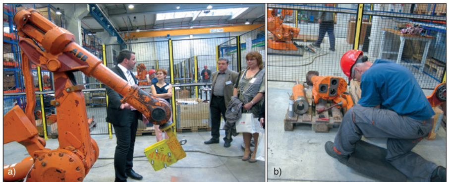
Obr. 2. Prohlídka jednotky repase robotů ABB: a) použitý robot je nejprve prohlédnut, b) robot je rozmontován a díly jsou opraveny nebo vyměněny
