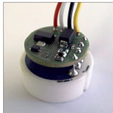
Obr. 3. Snímač OCS18 typu OEM s keramickou membránou
