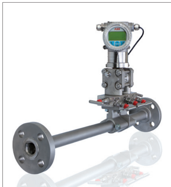
Obr. 4. Průtokoměr FPD510 IOMaster s výměnnými clonami a s uklidňujícími úseky potrubí před průtokoměrem i za ním
