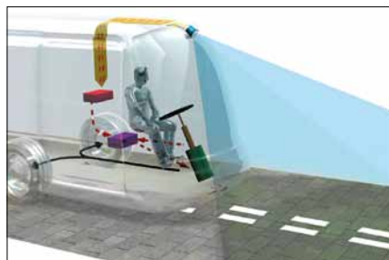
Obr. 3. Princip činnosti naváděcího systému Optiguide
