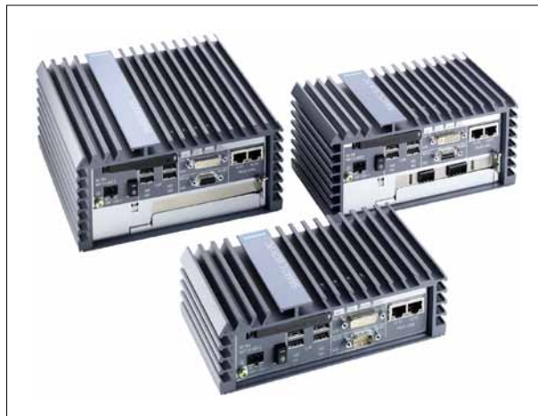
Obr. 3. Varianty přístroje Nanobox PC (zleva): PCIexpress, standardní, s digitálními I/O
