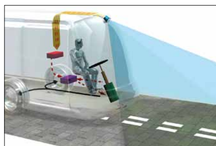
Obr. 3. Princip činnosti naváděcího systému Optiguide
