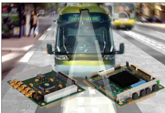
Obr. 1. „Mozkem“ navigačního systému Siemens Optiguide je vestavný jednodeskový počítač formátu PC/104 Microspace MSM800-SEL od firmy Kontron (vpravo); doplňuje jej digitalizační deska videosignálu (framegrabber) Microspace MSMG104+
