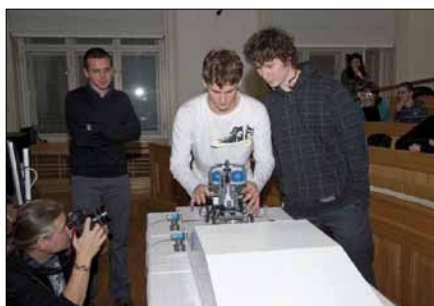
Obr. 1. Robot při individuální jízdě na startovním poli – patrný je počáteční tvar dráhy a uspořádání senzorů pro měření času
