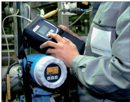
Obr. 6. Příložný ultrazvukový průtokoměr pro verifikaci funkce průtokoměru
