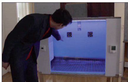
Obr. 1. Výuku řízení inteligentních budov na SPŠE v Pardubicích ztraktivnili stavbou vlastního modelu domku; při jeho řízení řeší nejenom světelné scény a ovládání žaluzií, ale i regulaci podlahového topení, přímotopného panelu a větrání (videozáznam je k dispozici na https://youtu.be/TH_s7qgYcjw )
