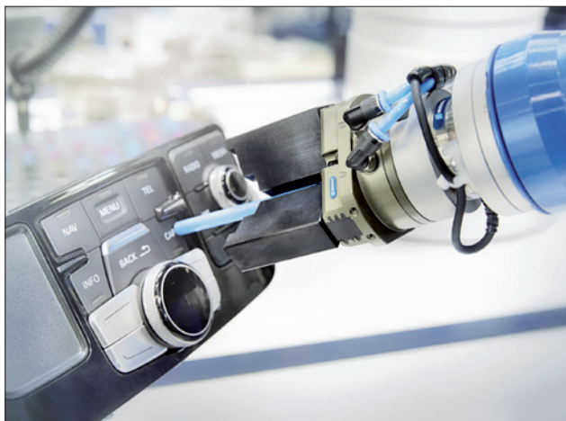
Obr. 6. Snímač síly FT při testování ovládacích prvků automobilu
