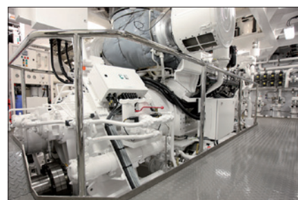
Obr. 2. Lodní převodovka vybavená energeticky nezávislým rádiovým systémem pro sledování stavu (foto: Reintjes GmbH)
