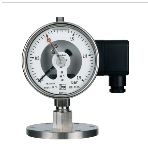
Obr. 2. Tlakoměr řady MAN-RF.M1.DRM-628 v antivibračním provedení (glycerinová náplň) se dvěma limitními kontakty a oddělovací membránou s připojením přírubou
