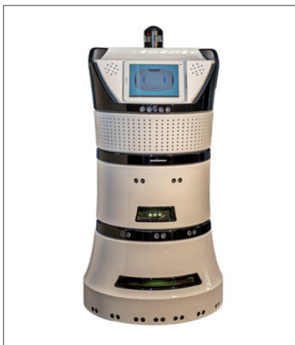
Obr. 4. Mobilní servisní robot pro čištění vzduchu Diya One (foto: Partnering Robotics)
