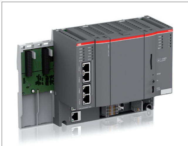
Obr. 1. PLC AC500 s procesorovou jednotkou PM595 a dvěma pozicemi pro bezpečnostní koprocetory či přidavné řadiče
