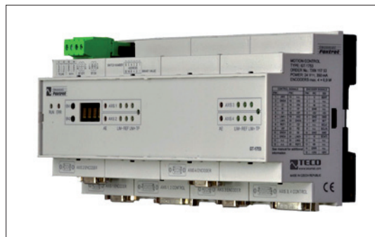
Obr. 2. Modul GT-1753 je určen pro Tecomat Foxtrot a řídí čtyři osy
