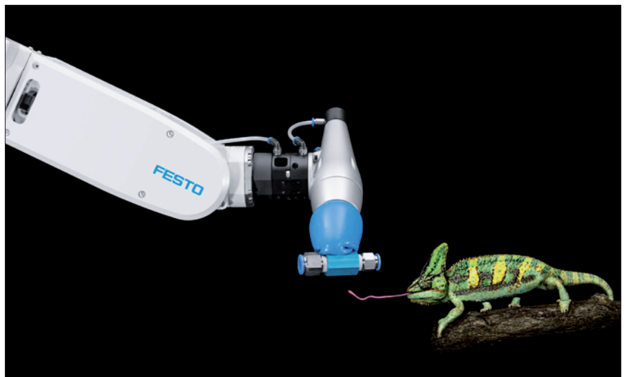
Obr. 3. Speciální uchopovač, jenž je analogií jazyka chameleona
