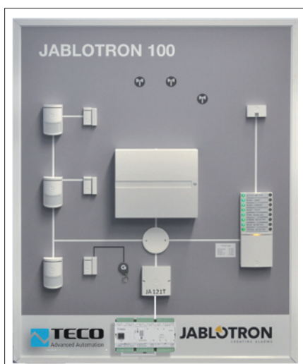
Obr. 1. Demonstrační panel možného spojení řídicího systému Tecomat Foxtrot s komunikační jednotkou JA121T a se zabezpečovací ústřednou JA100
