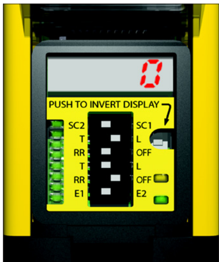
Obr. 2. DIP přepínače a displej pro nastavení závěsu EZ-Screen
