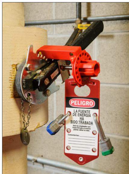
Obr. 4. Na uzamknuté zařízení se umístí zámky všech pracovníků údržby, kteří jsou v pracovním prostoru stroje
