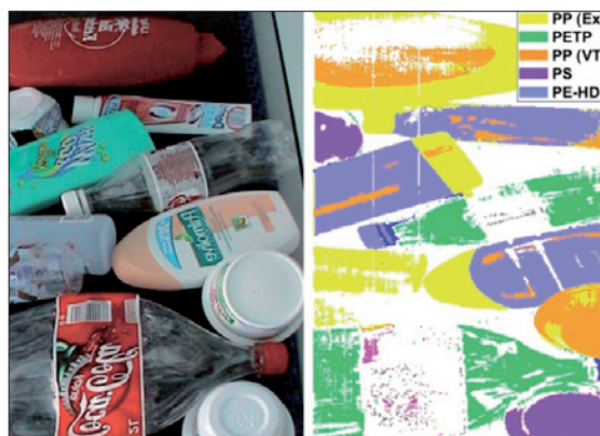
Obr. 3. Využití kamery Xenics Bobcat-1.7-320 v hyperspektrálním zobrazení při třídění plastů
