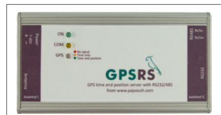
Obr. 3. Modul GPSRS umožňuje číst přesný čas protokolem Modbus RTU
