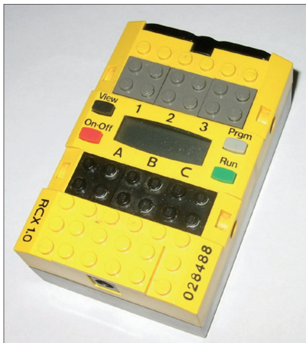
Obr. 1. První generace Lego Mindstorms RCX
