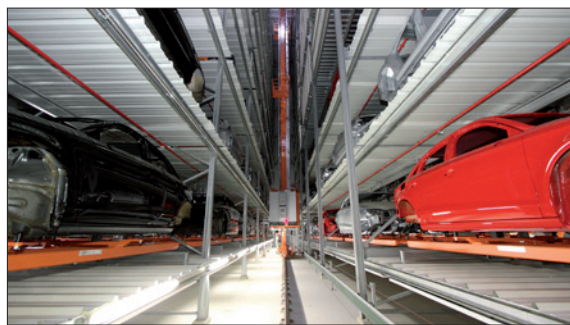
Obr. 1. Společnost Siemens vybudovala ve výrobním závodě firmy Audi v Győru v Maďarsku zcela automatizovaný vysokoregálový sklad určený jako centrální vyrovnávací sklad karoserií, zaujímající významné místo v systému výrobní logistiky v závodě; sklad je vybaven pohony značky Siemens a vyniká mimořádně efektivním využitím energie (zdroj: Audi AG)
