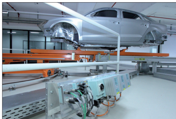
Obr. 2. Bezproblémový chod při optimálním prostorovém uspořádání mezioperačního dopravníku zajišťují pohony s prostorově nenáročnými distribuovanými měniči frekvence Simatic ET 200pro FC s krytím IP65
