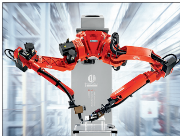
Obr. 3. Robot se dvěma rameny Smart Dual Arm je určen pro montážní operace a spoluprací s lidskou obsluhou (Comau)
