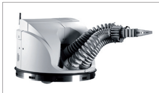
Obr. 2. Výukový robot Robotino s chapadlem Bionic Handling Assistant (Festo)
