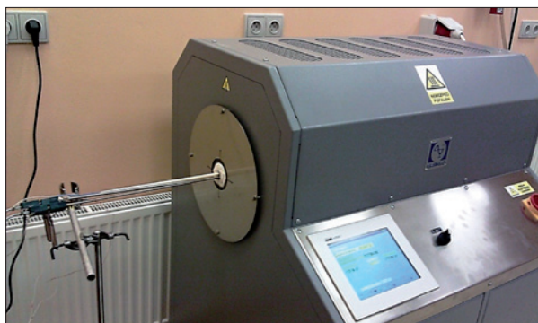
Obr. 1. Horizontální třízónová trubková pec pro zkoušky termoelektrických článků v laboratoři ČMI OI Praha
