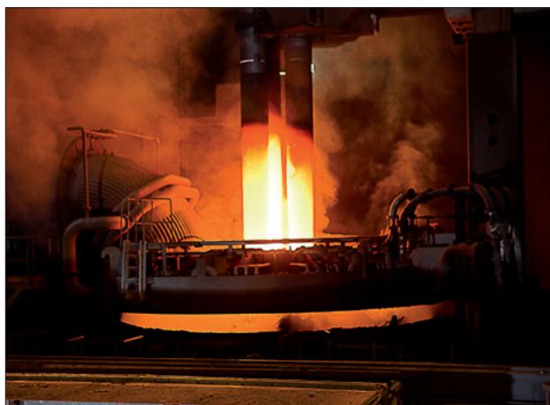
Obr. 1. Siemetal RCB Temp umožňuje přesně měřit teplotu taveniny v obloukových pecích
