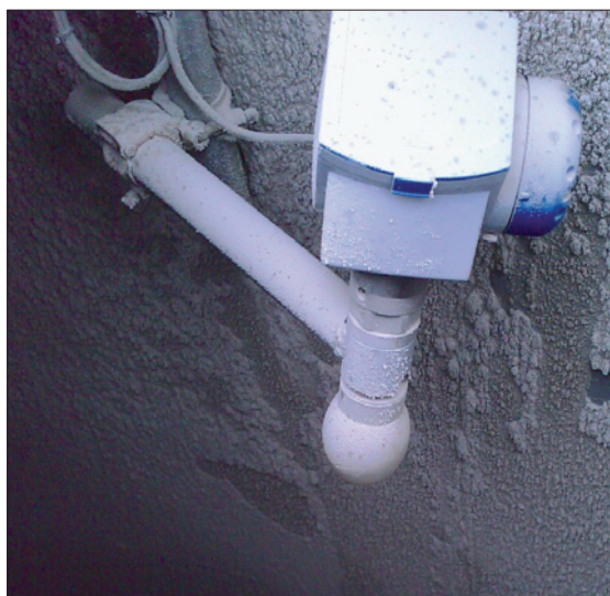
Obr. 2. Radarový hladinoměr Optiwave 6300 C se speciální kapkovitou anténou je zvláště vhodný k měření v prašném prostředí
