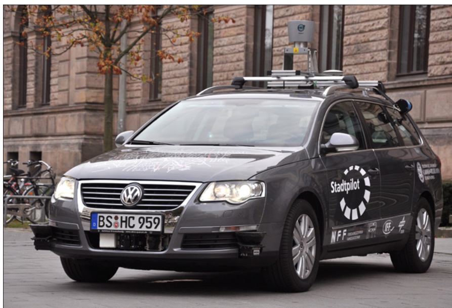
Obr. 2. Výzkumný automobil Leonie vznikl úpravou standardního vozu Volkswagen Passat 2.0 TDI (foto: TU Braunschweig)
