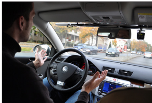
Obr. 1. Výzkumný automobil Leonie na městském okruhu v Braunschweigu: řidič zasahuje pouze na řízených křižovatkách či při přímém ohrožení (foto: TU Braunschweig)
