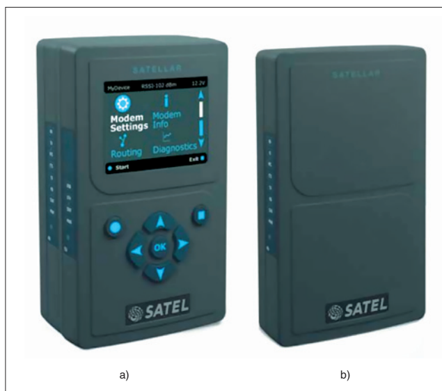
Obr. 3. Kombinace modulů: a) Satellar-2DSd s barevným displejem a ovládacími tlačítky zahrnuje radiomodem a centrální jednotku, b) Satellar-1DS je modul radiomodemu
