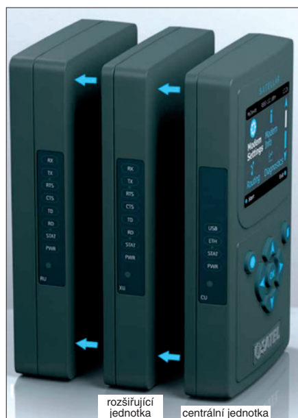
Obr. 2. Modulární struktura systému Satellar
