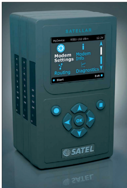
Obr. 1. Radiomodemový systém Satellar pro bezdrátovou komunikaci v reálném čase
