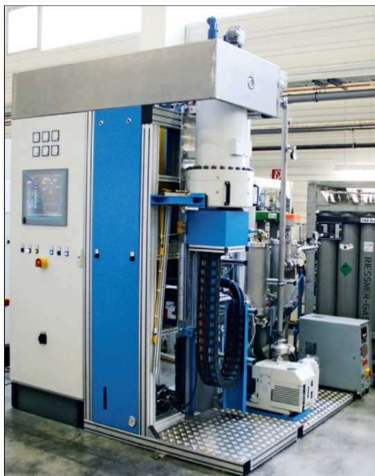
Obr. 1. Plynová tlaková pec pro spékání kovových a keramických materiálů
