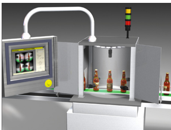
Obr. 2. Výsledky kontroly může obsluha sledovat na operačním panelu
