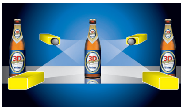
Obr. 1. Princip snímání systémem OmniView
