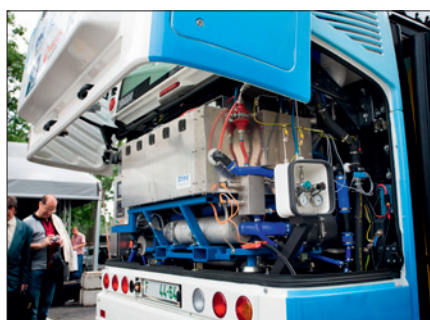
Obr. 2. Pohonná jednotka autobusu TriHyBus (Ústav jaderného výzkumu Řež, Zlatá medaile MSV 2010)
