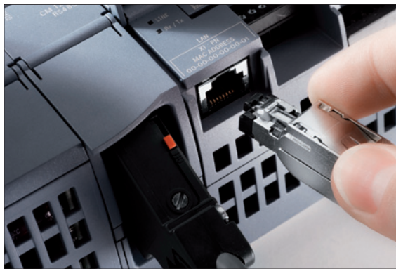
Obr. 3. Port Profinet vestavěný v základní jednotce řady S7-1200
