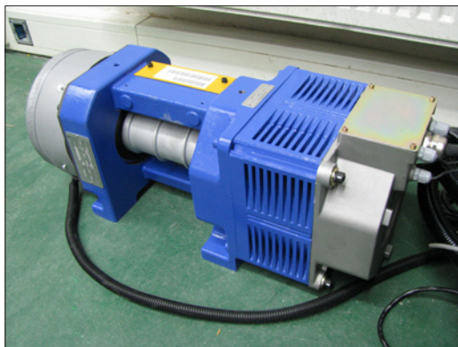
Obr. 2. Pomaluběžný synchronní výtahový motor o výkonu 3 kW s mechanickou brzdou a inkrementálním snímačem polohy
