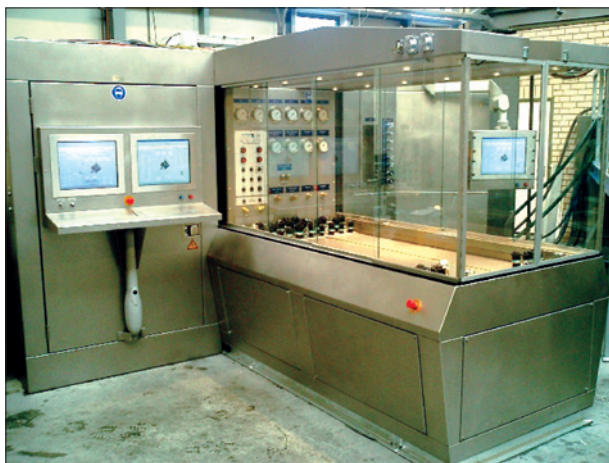
Obr. 1. Stanice pro zkoušení hydraulických součástí letadel byla instalována u několika zákazníků a významně snížila náklady na zkoušení
