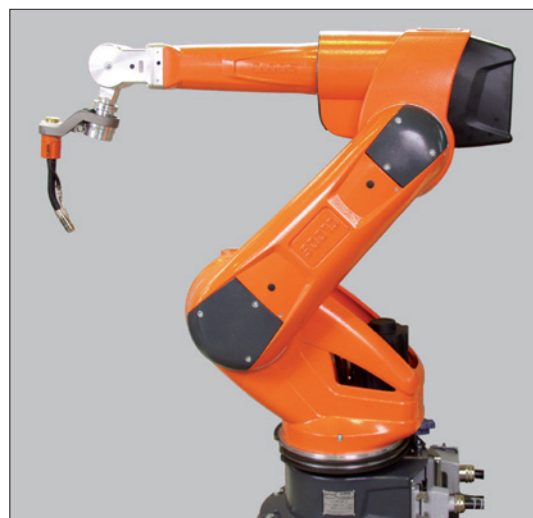
Obr. 3. Průmyslový svařovací robot Qirox od společnosti Cloos
