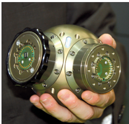
Obr. 5. Rotační modul Powerball SPD pro pohyb ve dvou osách (foto: Jiří Šmíd)
