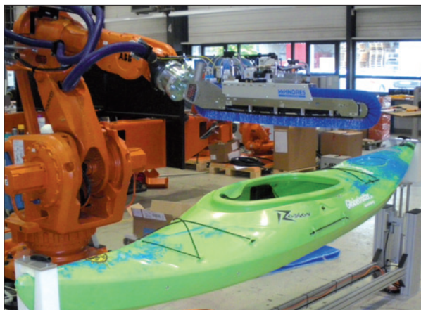
Obr. 2. Na exponátu kajaku ilustruje společnost ABB koncept RobotWare Force Control Machining
