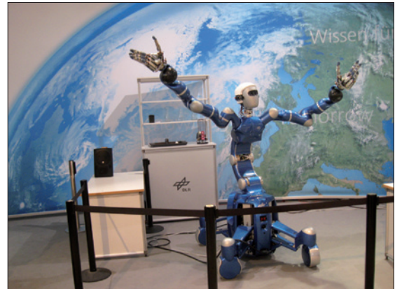
Obr. 6. Justin – experimentální platforma humanoidního robota pro využití v domácnosti nebo v kosmu
