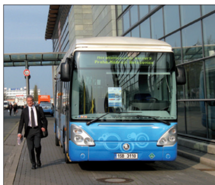
Obr. 3. Autobus s trojnásobným hybridním pohonem vznikl ve spolupráci německé společnosti Proton Motor Fuel Cell, která jej v Hannoveru vystavovala, a českých firem Škoda Electric a ÚJV Řež
