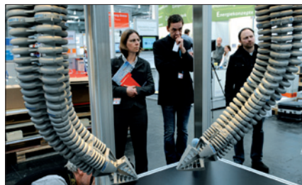
Obr. 4. Chapadla robotů inspirovaná sloním chobotem ve stánku společnosti Festo
