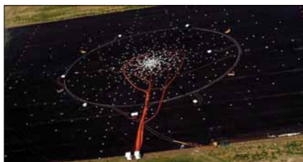
Obr. 1. Data z více než 600 mikrofonů umístěných na zemi jsou shromažďována a analyzována pro zjištění účinnosti opatření ke snížení hlučnosti
