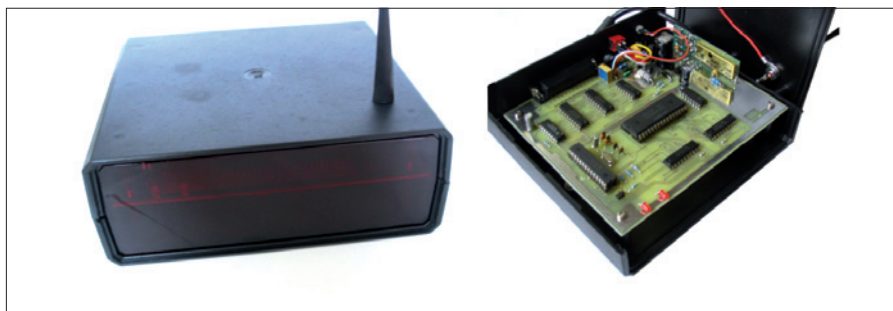
Obr. 3. Přijímač pro bezdrátová tlačítka
