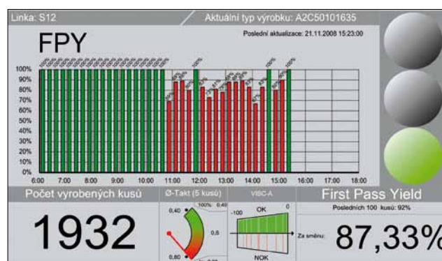
Obr. 1. Index FPY (First Pass Yield; procento dílů, které úspěšně projdou výrobním procesem napoprvé) je jedním z důležitých parametrů kvality výroby
