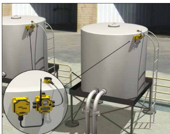
Obr. 1. Snímání hladiny ultrazvukovým senzorem připojeným na stanici DX70 s napájením z baterie
