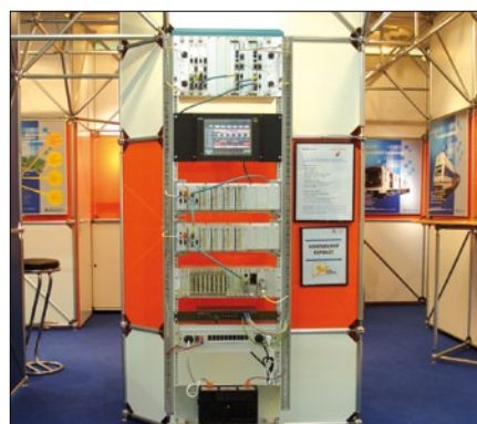
Obr. 4. UniTrack II – soubor technických a programových prostředků pro zajištění řídicích, diagnostických a komunikačních funkcí kolejových vozidel (Unicontrols, nominovaný exponát)
