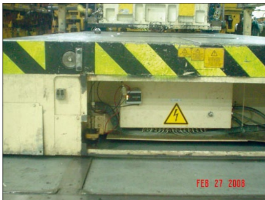
Obr. 2. Řešení: rádiový systém RadioLinx od společnosti ProSoft Technology (rádiová stanice na upínací desce)
