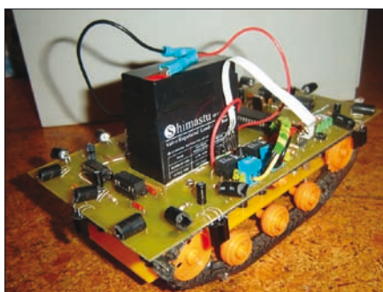
Obr. 1. Autonomní průzkumný robot ovládaný přes Bluetooth zvítězil v soutěži Kyber robot 2008
