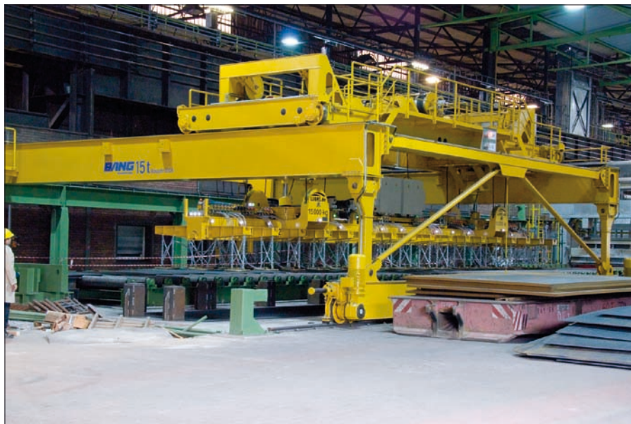
Obr. 1. Manipulátor plechů se dvěma nosníky o nosnosti 15 t opatřenými vakuovými přísavkami
