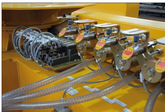
Obr. 2. Signály z jednotlivých vakuových přísavek jsou přenášeny do sběrných stanic I/O BL67
