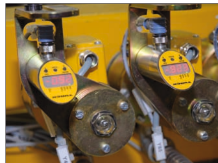
Obr. 3. Podtlak v přísavkách je zobrazován přímo na senzorech tlaku řady PS
